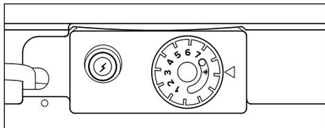
Prima o seletor B a fundo, mantenha-o premido e, em simultâneo, prima o acendedor piezoelétrico C. Através da abertura A, certifique-se de que a chama do queimador está acesa. Depois de se certificar de que a chama está acesa, mantenha premido o seletor B durante cerca de 20 segundos. Se a chama do queimador-piloto não permanecer acesa, repita a operação descrita anteriormente.
