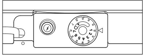
Para una mayor disponibilidad de agua caliente, se recomienda rodar el selector a la posición 5 y mezclar el agua para obtener la temperatura deseada.
