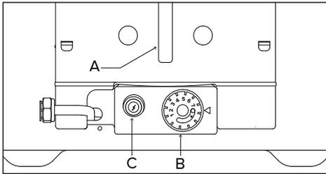
Llevar el selector B de la posición
