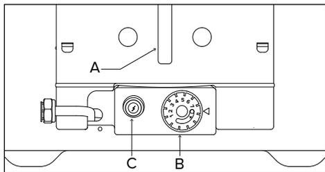
Desloque o seletor B da posição **O** (desligado) para a posição **★** (piloto).
