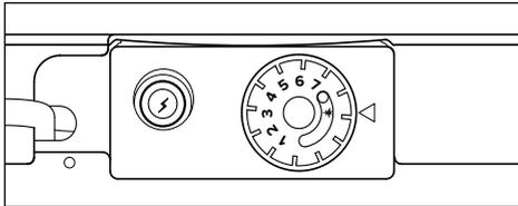
Presionar el selector B a fondo, mantenerlo presionado y simultáneamente pulsar el encendedor piezoeléctrico C.
